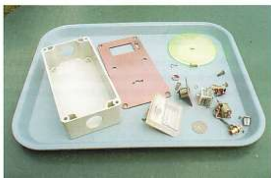
Alle mechanisch belangrijke onderdelen op een presenteerplaatje. Verzamel deze eerst, maak dan het frontpaneel (deksel) en houdt er rekening mee dat er ook nog twee 9V-batterijen in het kastje moeten passen. Werk het frontpaneel pas af als de sporen aan de binnenkant gefreesd zijn.
